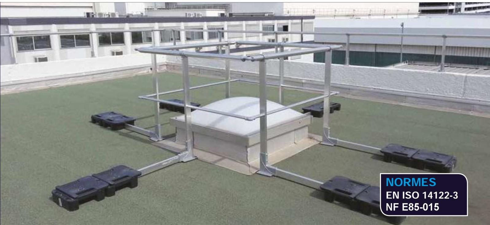
La protection de lanterneau VL VECTACO® permet une protection périphérique de tous les types de lanterneau. Cette structure autoportante évite toute intervention de perçage sur la toiture préservant ainsi l'étanchéité. Chaque montant est stabilisé par deux plots plastique avec semelles clipsées sous les embases. L'équipement est livré en kit.
